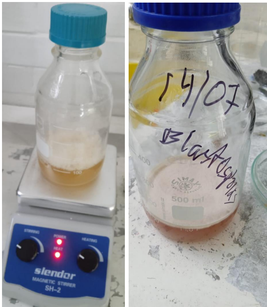
Agitamiento de la solución Papa-Dextrosa con el hongo entomopatógeno y Obtención de blastosporas para la inoculación del sustrato natural (arroz).
